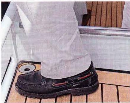
Konzeptionsbedingte Stolperfälle: Die 18 cm hohe Schottwand vor den Gangborden
