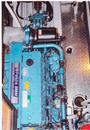
Der sechszylindrige Perkins-Diesel mobilisiert 154 kW
