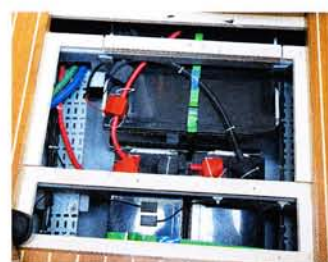
Praxisorientiert: Die Batterien stehen im Vorschiffsboden
